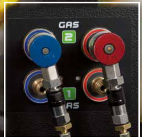
Schnellkupplungen für beide Kältemittel (nur bei 780R)
